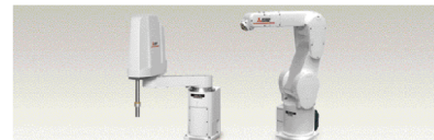
工業用機器人：SCARA、多關節機械手臂
